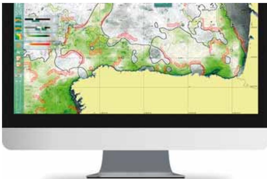
Los datos llegan a un servidor instalado en la sede de Marine Instruments y posteriormente expertos de la firma y de AZTI los procesan y analizan para localizar concentraciones de clorofila, controlar las corrientes o la temperatura, es decir, todo aquello que afecta al comportamiento del pescado. Una vez procesados, son enviados a los buques (de una manera automática), donde a través del nuevo software
